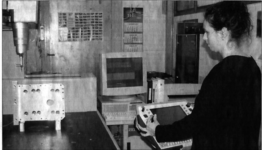
Heike Ebser mit der UPMC S-ACC 850 Carat der Firma Carl Zeiss/Oberkochen. Die Maschine hat eine Längenmessunsicherheit von 0,0004 Millimetern; diese genaueste unter den Zeiss-Messmaschinen, die als deren Top-Modell gilt, ist zudem in der Lage, Teile zu vermessen, die einhalb Tonnen schwer sind. Foto: bt
